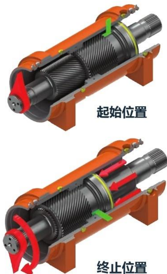
双螺旋传动工作原理示意（结构参考）
